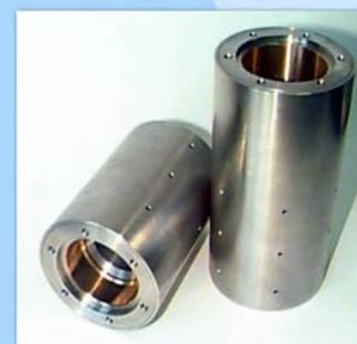
Модели для изучения взаимодействия бериллиевого покрытия первой стенки с водяным паром для верификации компьютерных кодов моделирования аварийной ситуации потери теплоносителя в реакторе ИТЭР.
