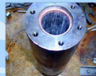
Модель после испытаний в среде водяного пара при 1000°C.
